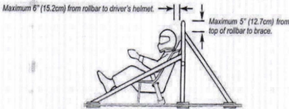
либо дуг (rollbar) заводского изготовления. В случае самостоятельного изготовления материал изготовления дуг должен соответствовать п.8.3.3 ст 253 Приложения J. Крепления дуги осуществляются в штатных точках, либо через закладные в соответствии с требованиями п.8.3.2.6 ст.253 Приложения J.
